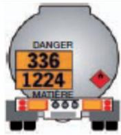
Les véhicules transportant des matières dangereuses ou radioactives sont identifiables par un des logos suivants, apposés notamment à l'arrière droit du véhicule.
